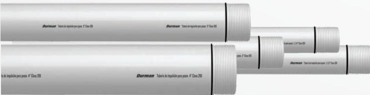
Cada uno de los tubos de 1 1/4" y 1 1/2" son fabricados con rosca macho y hembra, lo que significa que **NO NECESITAN DE UNIÓN ADICIONAL**. Los tubos de 2", 3" y 4" son fabricados bajo con rosca macho en los dos extremos, por lo que **NECESITAN UNIÓN ADICIONAL**.
